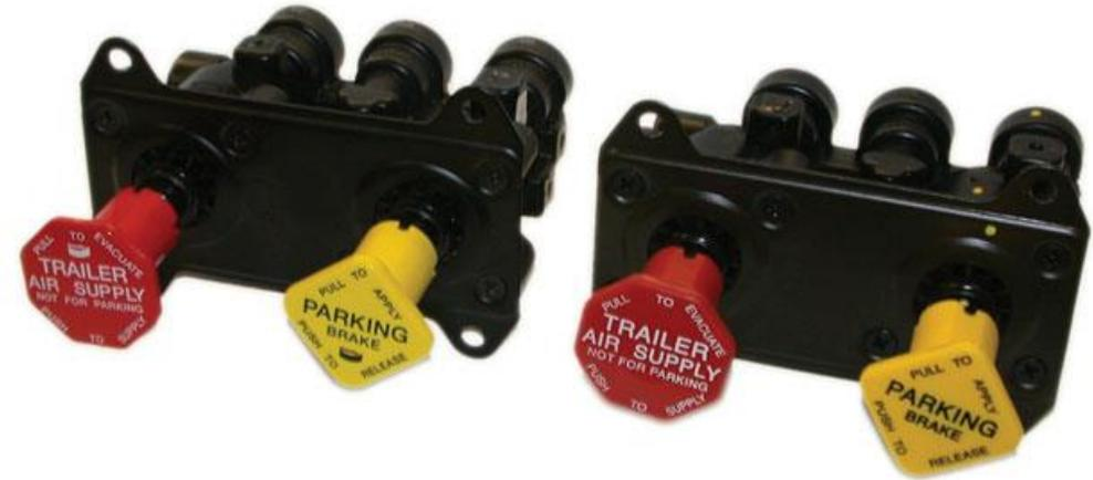
*Erkennen Sie den Unterschied? Das Original (links) und die Fälschung (rechts) eines Bendix MV-3 Bremsdruckluftventils sind äußerlich kaum zu unterscheiden.\*\*)*
